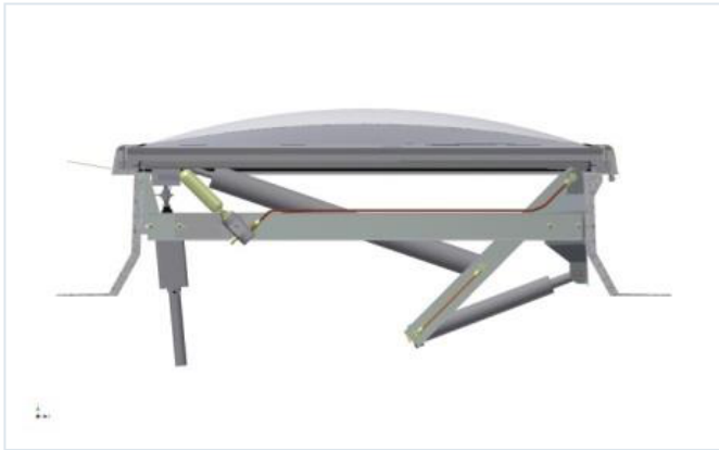
Geöffneter Beschlag mit Antrieb
